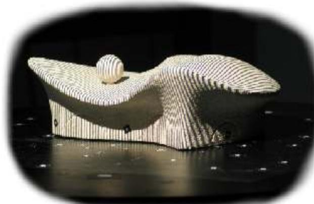
Der Datensatz repräsentiert nun die Außenhaut des Modells. Von dieser Basis aus können Innenräume, Fenster und Türen, die Tragwerkskonstruktion bis hin zum transportfähigen Fertighauselement konstruiert, statisch überprüft und dimensioniert werden. Es können auch Photopolymerisationsverfahren zur Modellreproduktion (hier im Maßstab 1:500) gesteuert werden.
